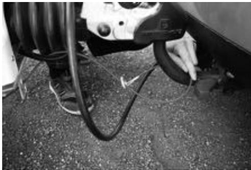
もし、ケーブルに損傷がある場合は新品と交換してください。
